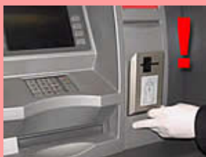
Okienko wrzutowe z założonym dodatkowym czytnikiem kart
